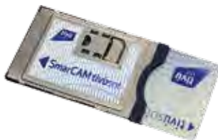
Tivùsat CAM HD module inclusief SMART Card Geschikt om Tivùsat programma's, ook HD, via satelliet met de Force HD CI+ ontvanger te bekijken.
